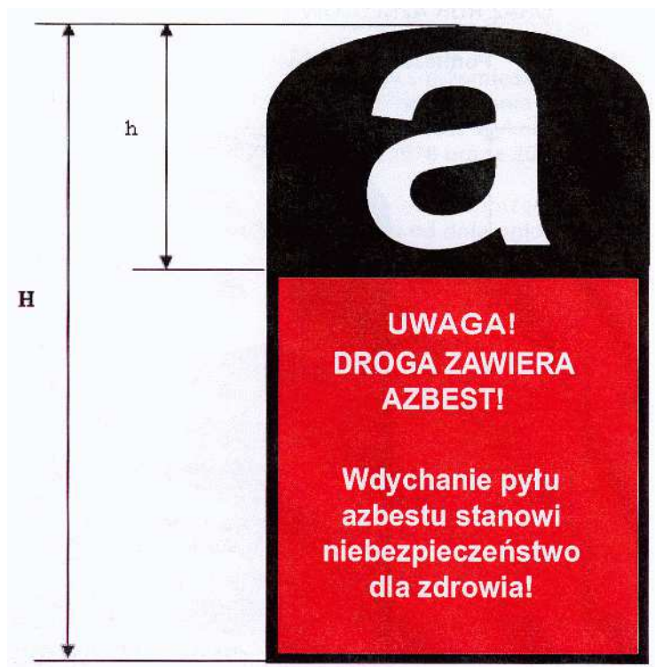
Ryc. 9. Wzór oznakowania dróg utwardzonych odpadami zawierającymi azbest przed wejściem w życie ustawy z dnia 19 czerwca 1997 r. o zakazie stosowania wyrobów zawierających azbest, ale niezabezpieczonych trwale przed emisją włókien azbestu
